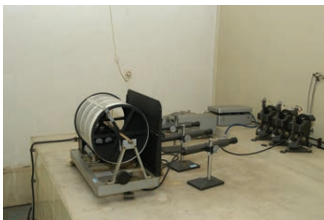
Инструменти во Сеизмолошката опсерваторија при ПМФ во Скопје: (лево) механички сеизмограф MAINKA; (десно) фреквентно ограничени (пасивни) електромагнетски сеизмометри со галванометриска регистрација врз фотографска хартија поставена на цилиндер што ротира
