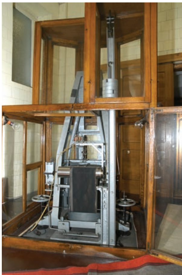
Инструменти во Сеизмолошката опсерваторија при ПМФ во Скопје: (лево) механички сеизмограф MAINKA; (десно) фреквентно ограничени (пасивни) електромагнетски сеизмометри со галванометриска регистрација врз фотографска хартија поставена на цилиндер што ротира
